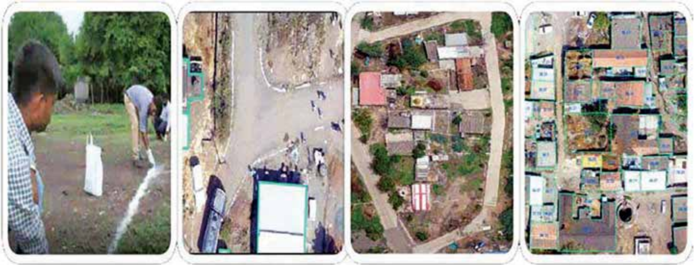
‘स्वामित्व योजना’ के तहत ड्रोन तकनीक से ग्रामीण क्षेत्रों में भूमि पार्सलों के सर्वेक्षण और मानचित्रण का कार्य किया जा रहा है। सर्वेक्षण चार वर्षों (2020–2024) की अवधि में चरणबद्ध तरीके से पूरा किया जाएगा।
