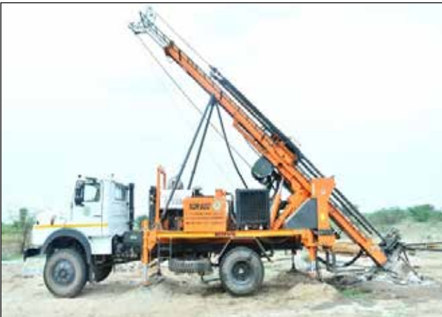
चित्र-4. खनिज अन्वेषण कार्य में लगी जीएसआई की ट्रक पर लदी हाइड्रोस्टैटिक ड्रिल मशीन
